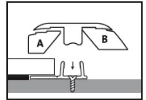
En primer lugar, sierre el perfil hasta lograr la longitud adecuada. Con ayuda de la cuchilla, corte la sección A para formar un perfil de adaptación.
