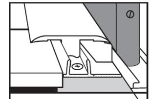
En primer lugar, sierra el perfil hasta lograr la longitud adecuada. Con ayuda de la cuchilla, corte la sección B para formar un perfil de borde.
