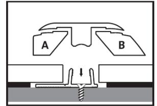
Sierre el perfil hasta lograr la longitud adecuada. Corte la sección A y la B con la cuchilla para formar el perfil de dilatación.
