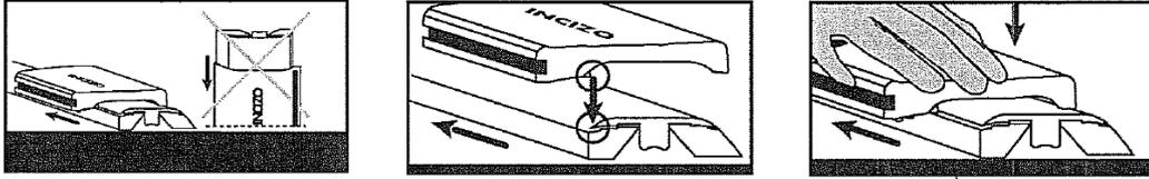
Al hacer el corte, coloque siempre el perfil horizontalmente en una base estable.
