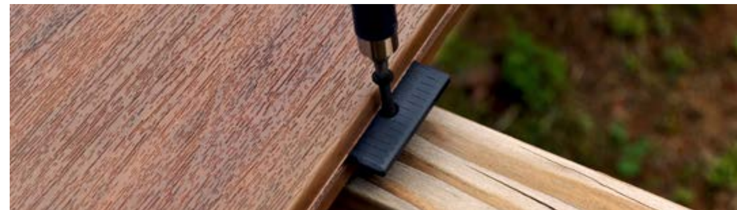
Para la fijación universal Phantom, la grapa se instala en la ranura. Posteriormente, se coloca un tornillo sobre la viga (a 90°).
